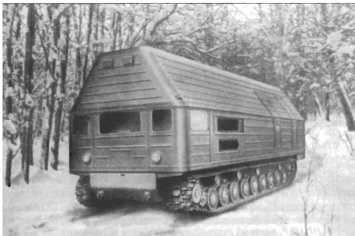
Блок паропроизводящей установки
