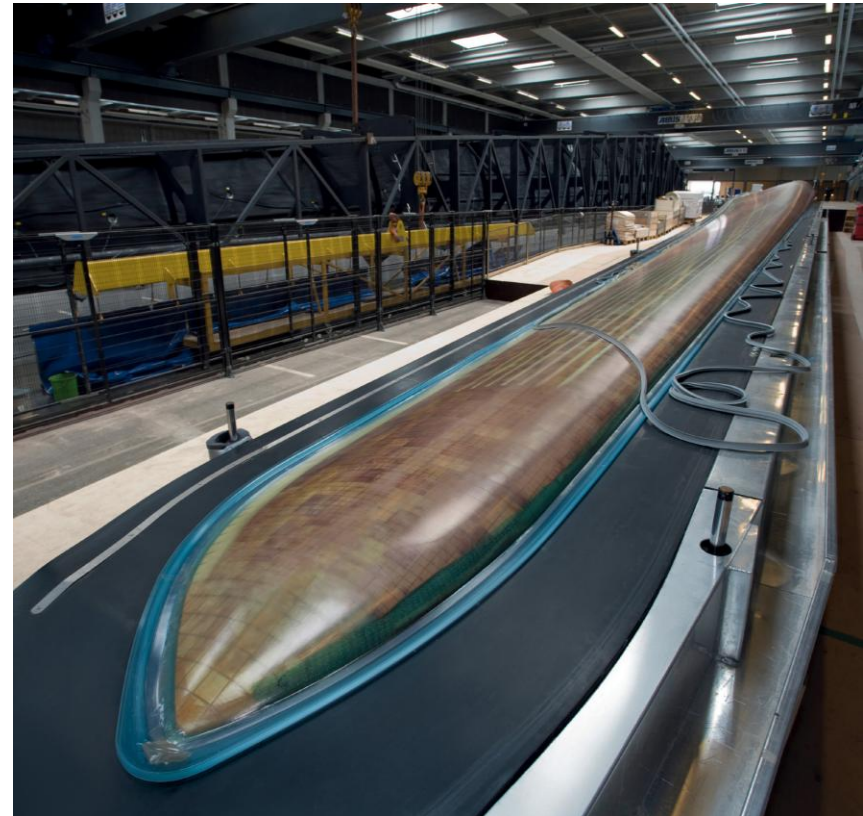
Отливка цельной лопасти SWP в Ольборге
