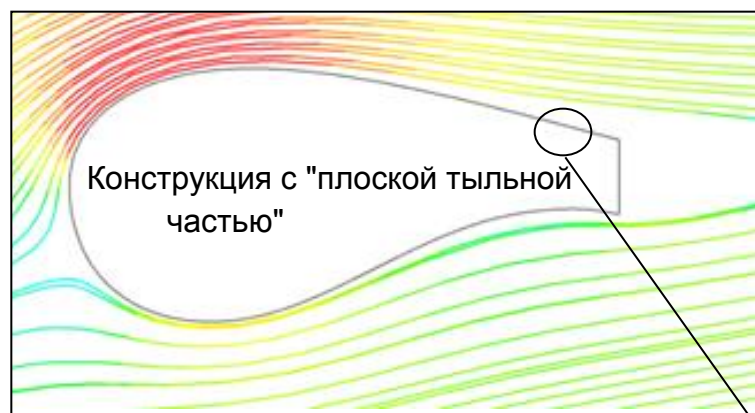
Воздушный поток вокруг сечения основания В49
